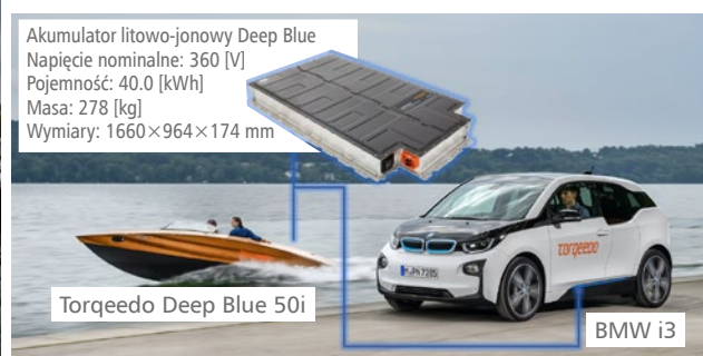
Rys. 2. Akumulatory stosowane w łodziach serii Deep Blue oraz pojazdach BMW [4]
