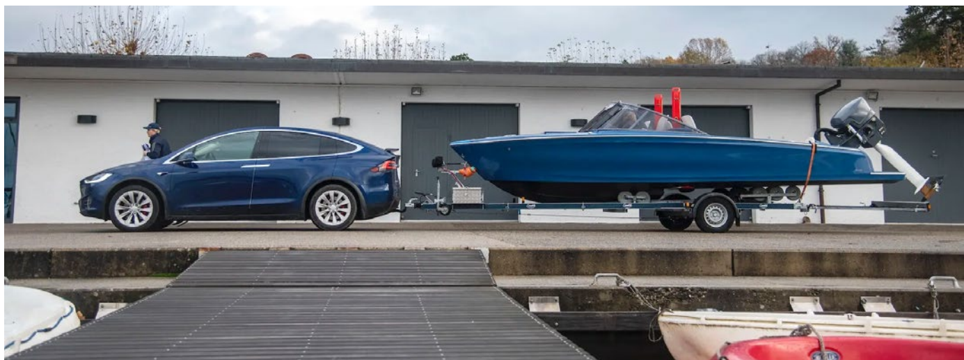
Rys. 5. Tesla Model X wraz z elektryczną łodzią Candela (płaty nośne podczas transportu i niskich prędkości są podniesione) [9]
