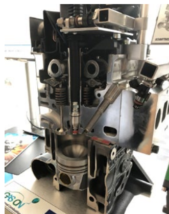
Rys. 7. Widok systemu spalania szybkoobrotowego silnika gazowego dedykowanego do samochodów osobowych.
