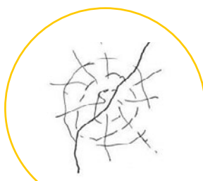
Rys. 7. Pęknięcie laminatu, tak zwany „pająk”
