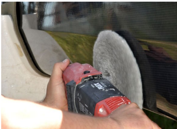
Rys. 6. Polerowanie kadłuba przy pomocy futerek z włosia owczego
