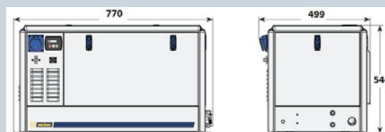
Rys. 2. Wymiary generatora 5 kVA, model GHX5
