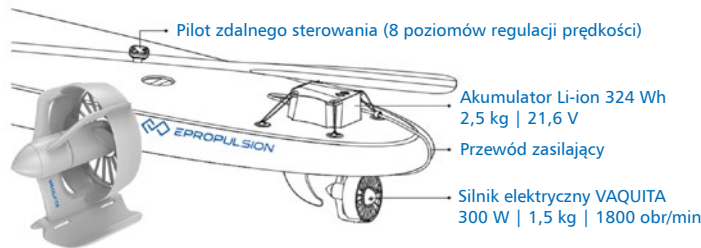
Rys. 5. Silnik elektryczny Vaquita firmy ePropulsion przeznaczony do zastosowań w deskach SUP [7]
