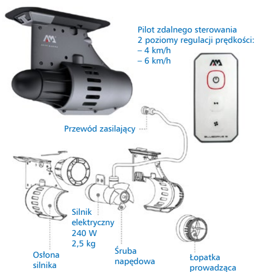
Rys. 6. Silnik elektryczny BlueDrive S Power Fin firmy Aqua-Marina [8]
