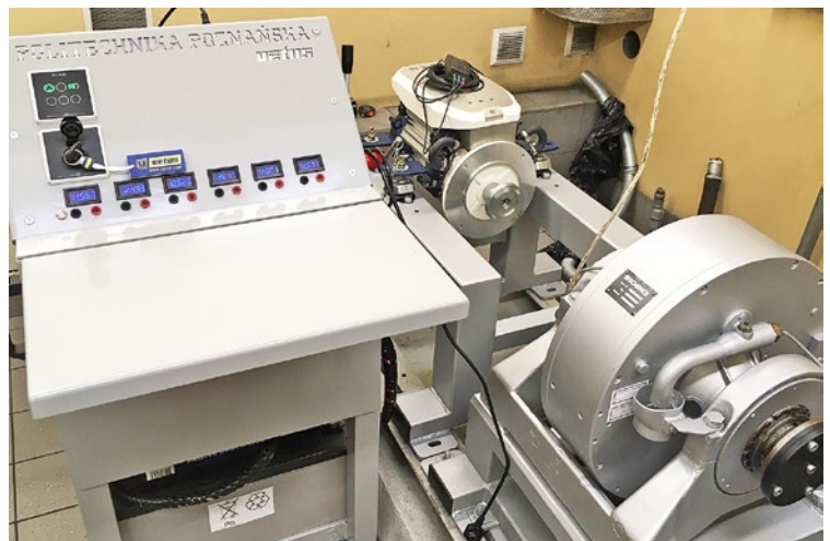
Rys. 14. Silnik do zabudowy wewnętrznej (stacjonarny) E-Line firmy VETUS [16]
