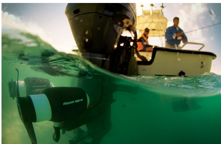
Rys. 10. Silniki uciągowe firmy Minn Kota zamontowane na płycie kawitacyjnej spalinowego silnika zaburtowego [11]
