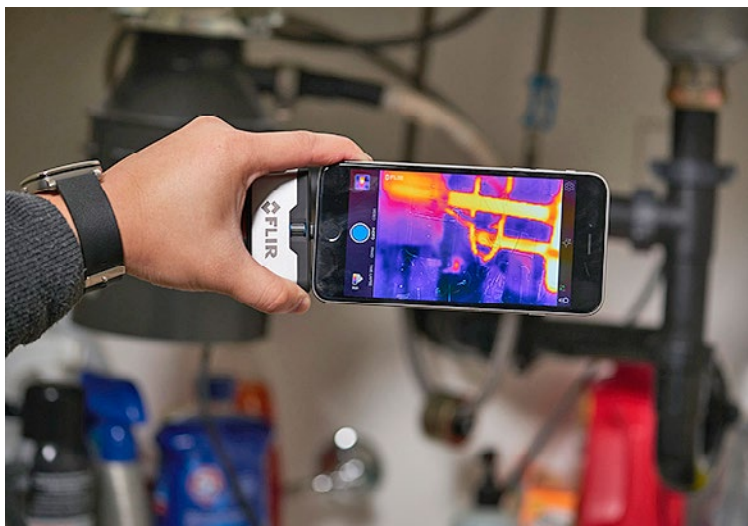
Rys. 21. Kamera termowizyjna marki FLIR podłączana do telefonu [25]
