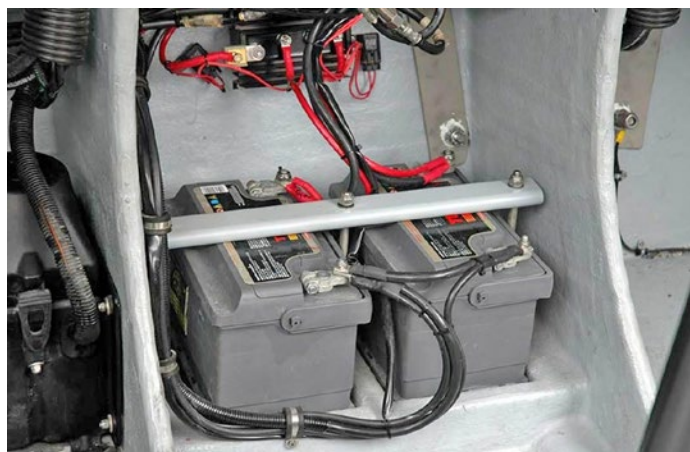
Rys. 6. Lokalizacja akumulatorów 2x12 V pod pokładem [15] (analiza podłączenia: akumulatory zabezpieczone przeciw przemieszczaniu, dobra wentylacja, brak osłon terminali/akumulatorów)
