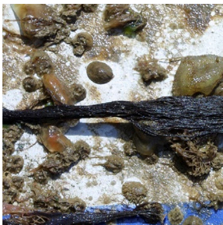
Rys. 2. Niezabezpieczone dno kadłuba jachtu porośnięte glonami, porostami, skorupiakami i wszelkimi innymi zabrudzeniami
