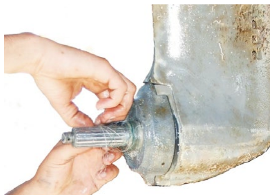
Rys. 4. Usuwanie żyłki nawiniętej na wał śrubowy napędu S
