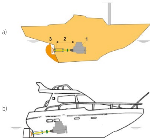
Rys. 1. Napęd mechaniczny (maszynownia) jachtu
