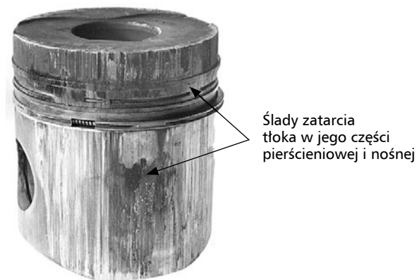
Rys. 6. Zatarty tłok silnika o zapłonie samoczynnym (silnika Diesla) na skutek niedostatecznego chłodzenia
