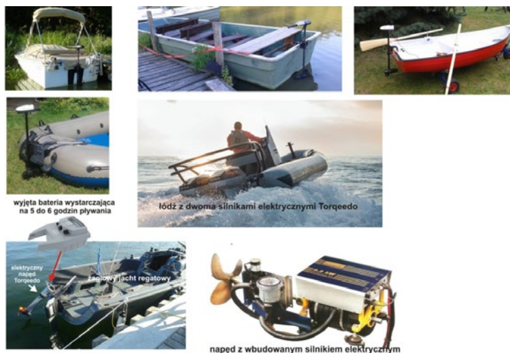
Rys. 1. Silniki elektryczne w napędach niewielkich łodzi
