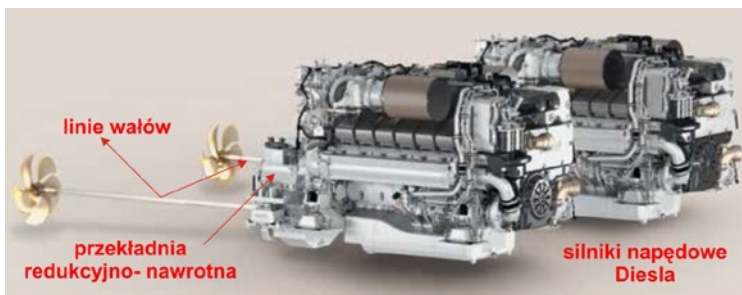
Rys. 8. Schemat napędu spalinowo-mechanicznego
