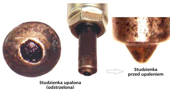
Rys. 10. Uszkodzenie rozpylacza w układzie wtryskowym Common Rail
