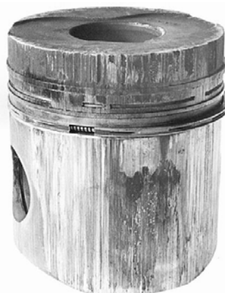
Rys. 3. Całkowicie zatarty tłok na skutek nadmiernego obciążenia cieplnego [6]
